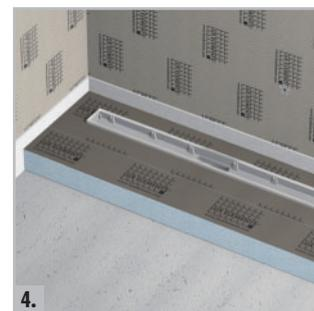
1. Обрезать присоединительный элемент при помощи универсального ножа в зависимости от направления трубы. / 2. После монтажа сточной трубы при помощи колена НТК она будет надежно защищена присоединительным элементом / 3. + 4. Монтаж присоединительного элемента (в зависимости от направления трубы) возможен как со стороны стены, так и ближе к центру помещения.
