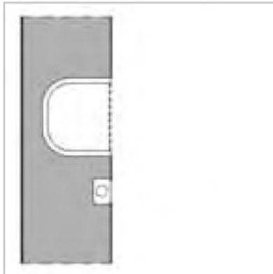
esim. upporasian (tai johdon) asennus ELEMENT- levyyn
