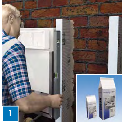
1 Klæb korrekt tilskårne ELEMENT-EL 50 til murværket med COL-AK, så de er i lod og flugter.
