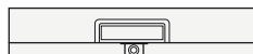
■ TUB-WALL RT 1 1200/200 200 x 1200 x 70 mm, mono pente, platine d'étanchéité séparée 370 x 1300 mm
